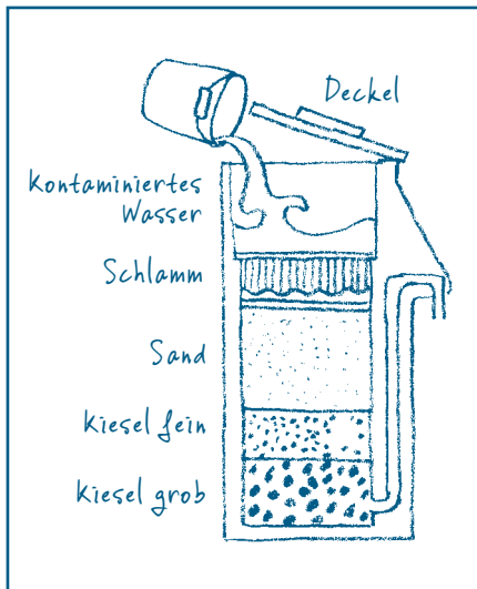
Wie in einer Kläranlage reinigen Kies, Sand und Schlamm in Sandfiltern das Wasser.
