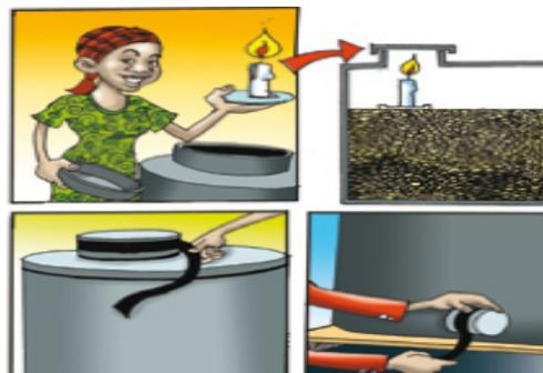
Figure 14: Silo Metálico com Vela acesa (retirar oxigénio) e borracha para fechar o orifício de entrada e saída do grão (não entrada de oxigénio).
