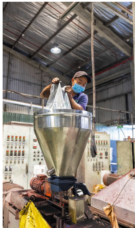
Oben (v.l.n.r.): Aus Kakaoschalen wird Pflanzenkohle wird Bioplastik. Ein Arbeiter füllt die Kohle in einen Behälter, wo sie mit Kunststofffasern gemischt und erhitzt wird. In einem Wasserbad wird sie gekühlt, bevor sie zu Granulat geschreddert wird.
