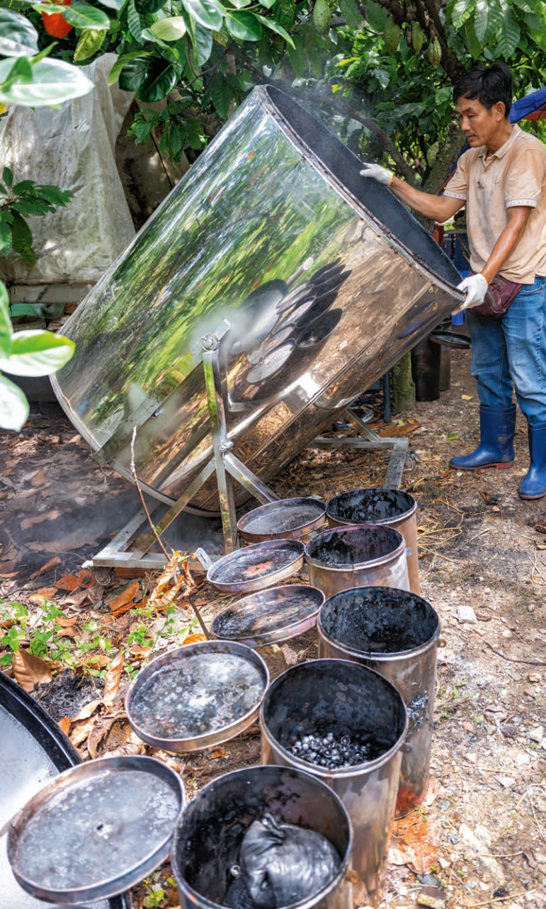
Oben: Mit Pyrolyse stellt Hoang Nguyen aus Schalen von Kakaofrüchten und anderen Pflanzen Pflanzenkohle her. Diese kann als Dünger oder zur Produktion von Bioplastik verwendet werden.
