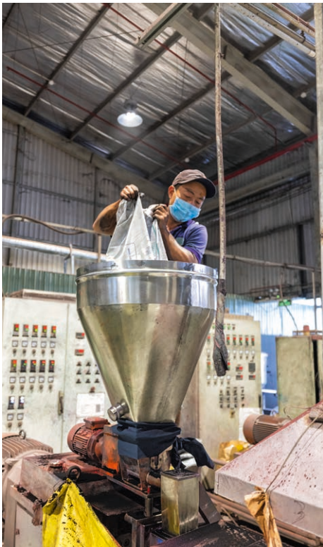
Oben (v.l.n.r.): Aus Kakaoschalen wird Pflanzenkohle wird Bioplastik. Ein Arbeiter füllt die Kohle in einen Behälter, wo sie mit Kunststofffasern gemischt und erhitzt wird. In einem Wasserbad wird sie gekühlt, bevor sie zu Granulat geschreddert wird.
