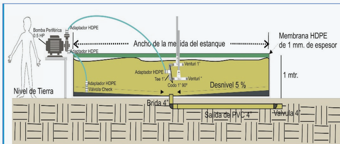
Gráfico 01: Esquema de sistema de oxigenación utilizado en el distrito de Suyo.
