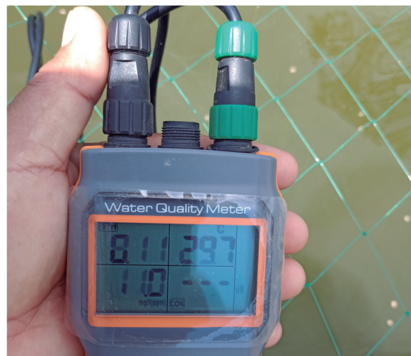
Lectura de oxígeno disuelto en geotanque de crianza de Tilapia.
