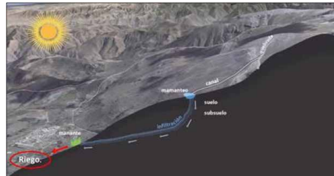
FIGURA 3 - ESQUEMA DE LA IDEA DE FUNCIONAMIENTO DE LOS CANALES EN EL SISTEMA DE MAMANTEO.
