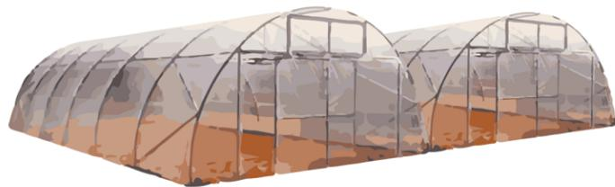
Se caracteriza por la forma de la estructura del invernadero que se asimila a un túnel y de ahí se deriva el nombre. Se pueden utilizar postes de madera o de metal en la estructura. También se pueden utilizar otros materiales disponibles en la localidad como el bambu. Sobre los postes se colocan tubos pvc, que son utilizados como arcos, que llevan una varía de hierro de 3/4 en su interior. La altura máxima de este tipo de invernaderos en la cumbre es de 4.50 metros. En las
