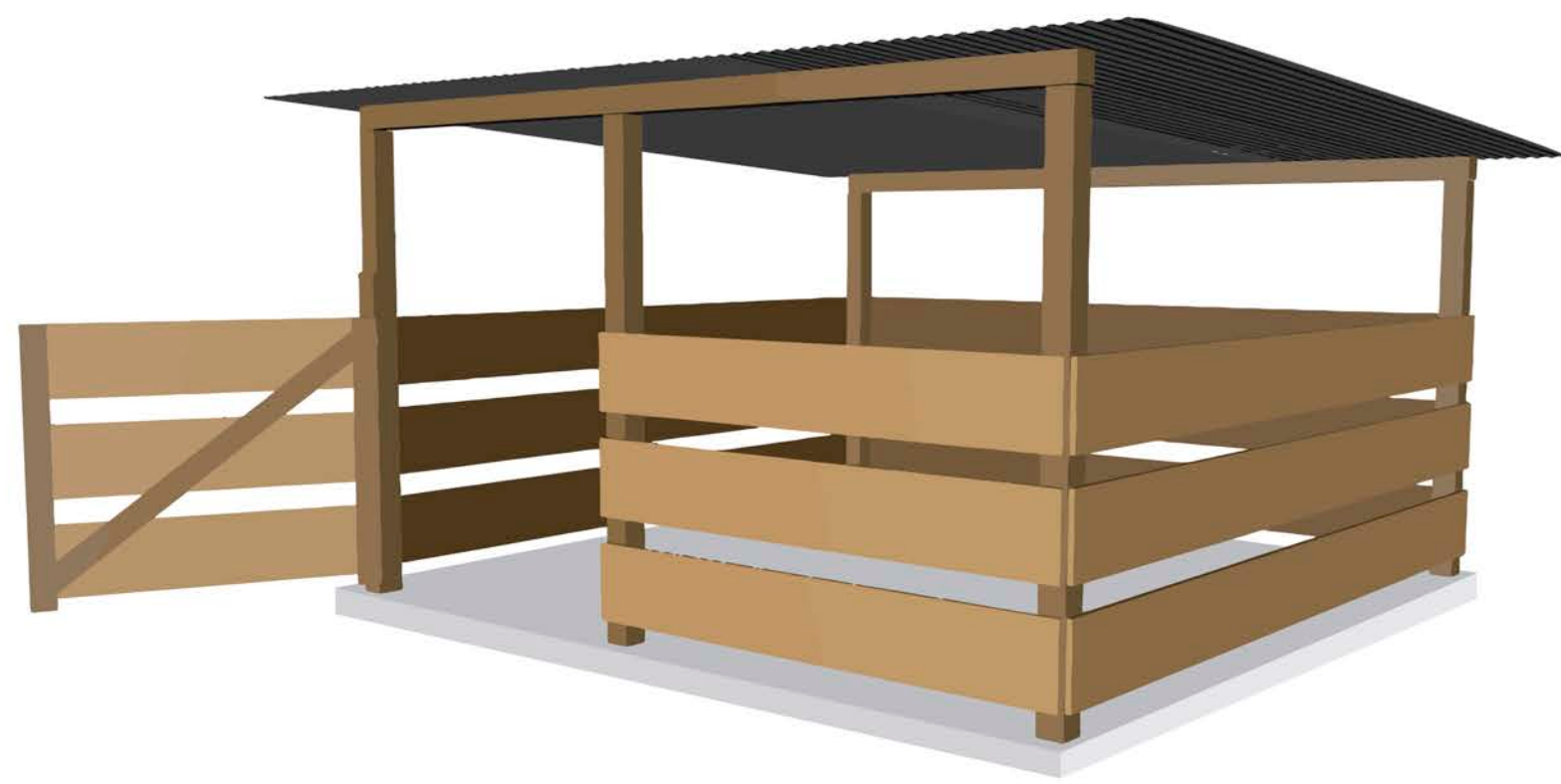
Piso de concreto de cemento y paredes de tabla o block
