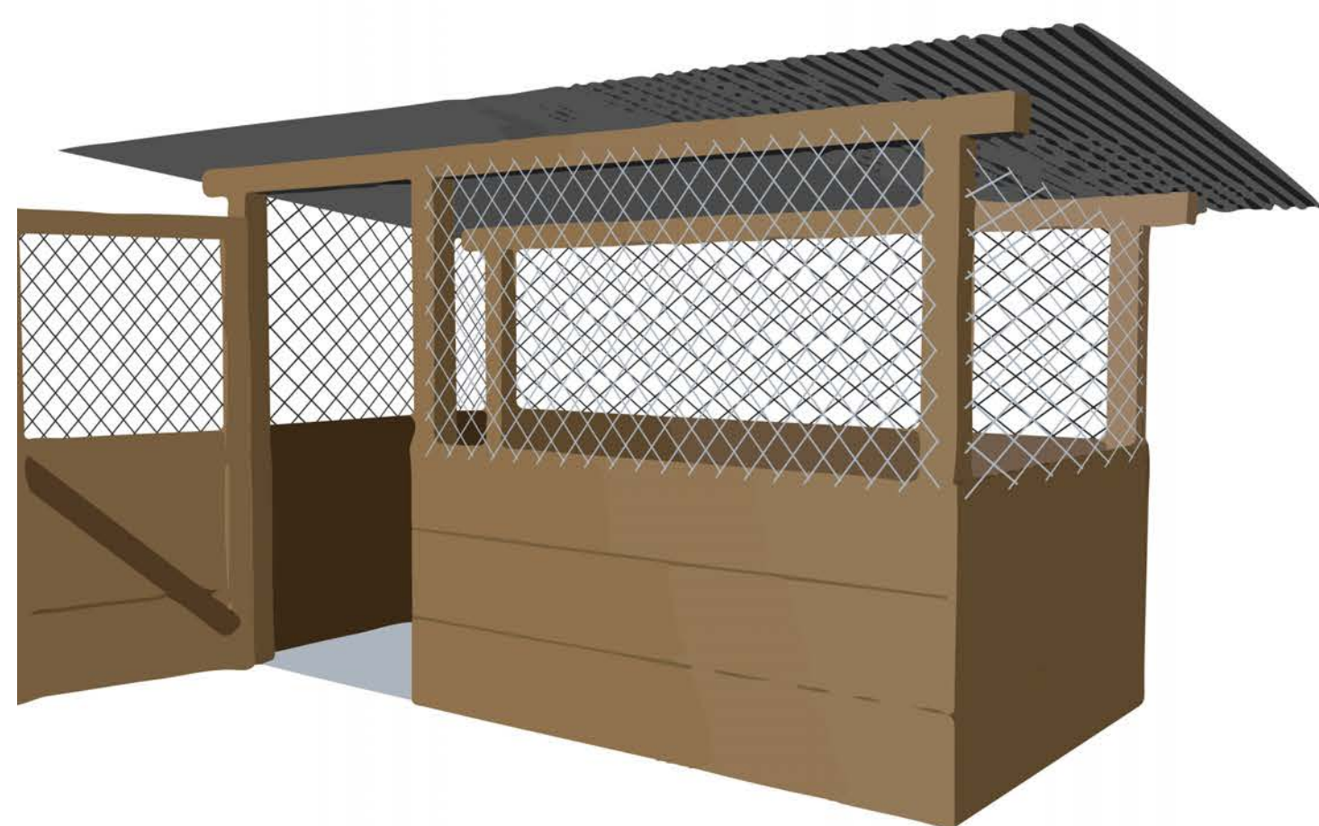
Piso de concreto de cemento y paredes de tabla o block
