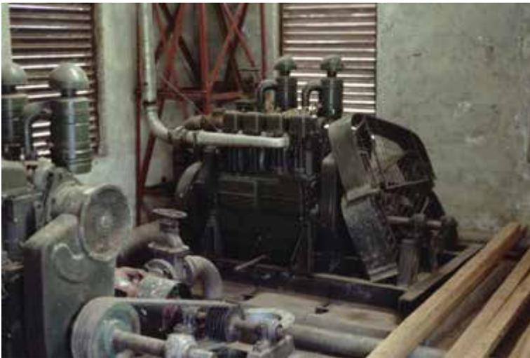
32. Diesel-Wasserpumpe am Victoriasee, Kenia. Kompliziert, Betrieb zu teuer, Pumpe ging nie in Betrieb (Frustration)
